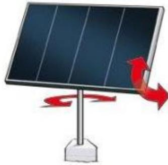
Figure III.5 Orientation du suiveur double-axe.
