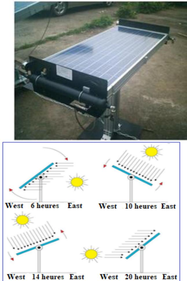
Figure.III.2 Exemple de Suiveur passif
