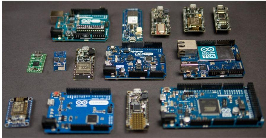
**Figure I.6** Exemple de cartes de développements électroniques à base de microcontrôleurs
