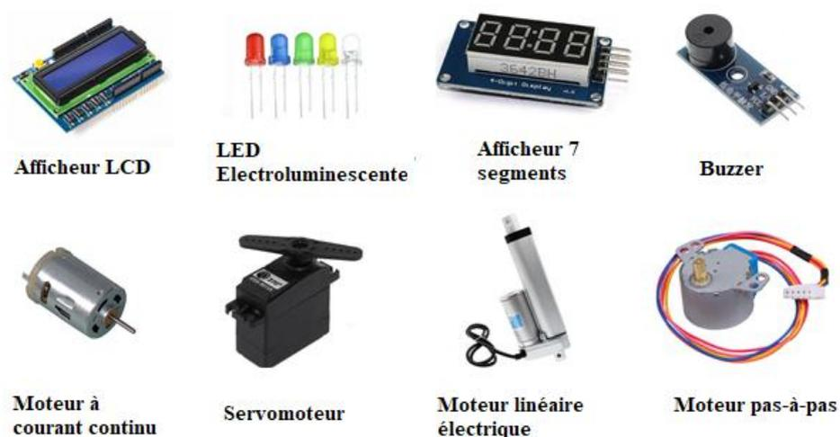
**Figure I.7** Liste de quelques actionneurs
