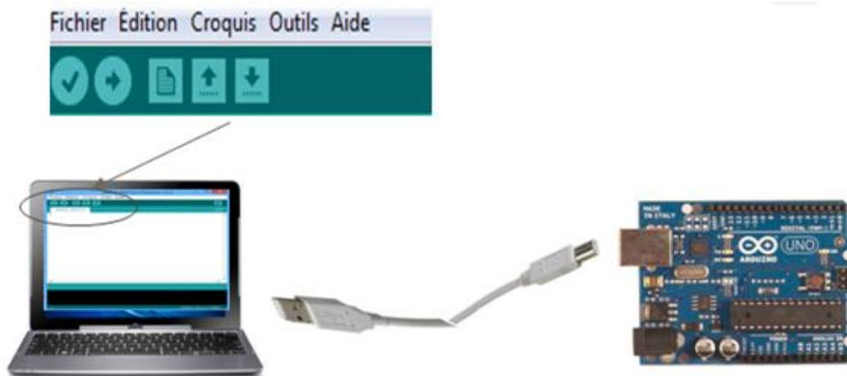
Figure II.9 Schéma de téléversement.
