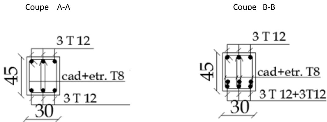
**Fig IV.11 : Ferrailage de la poutre palière.**
