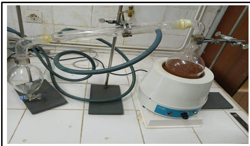
Figure 2-3 : Dispositif d'hydro-distillation lors d'extraction des huiles essentielles
