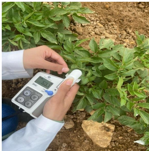
Figure 8: L'intensité Chlorophyllienne mesurée à l'aide du SPAD
