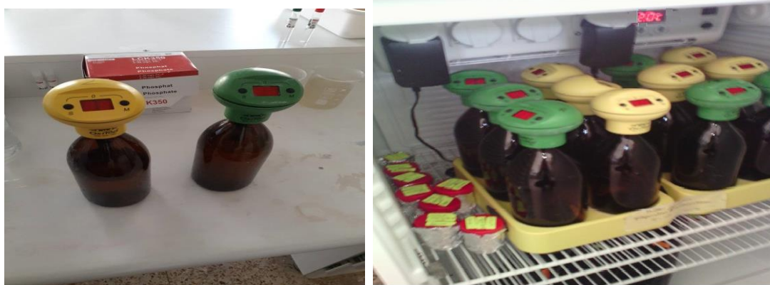
Fig. 8. Flacon équipé de manomètre de la marque OxiTop .
