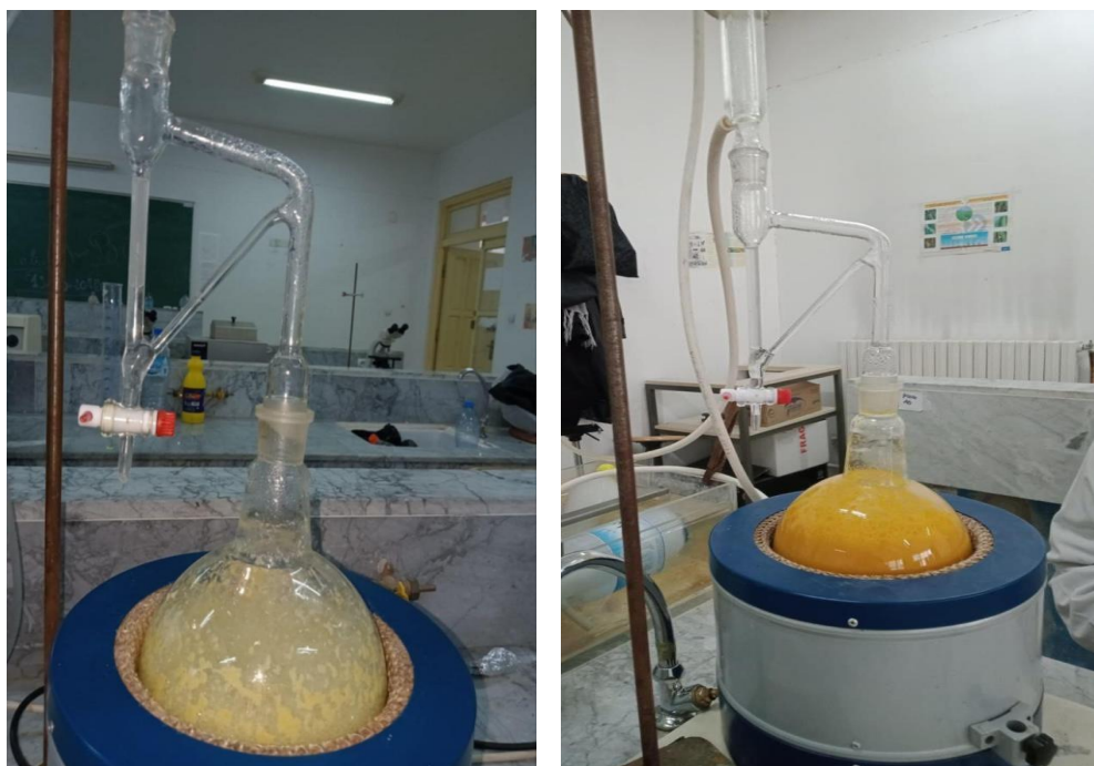
Figure15 : Montage d'extraction (Clevenger).
