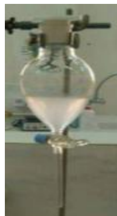
Figure 17 : Ampoule à décantation
