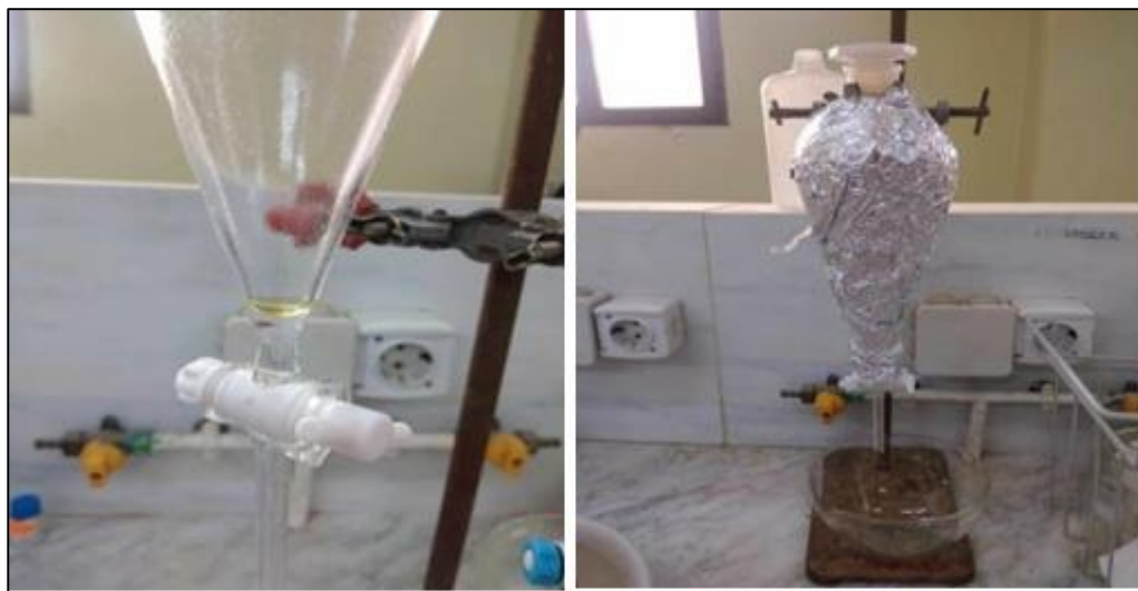
Figure.20: Une ampoule a décanté pour la séparation d'une huile essentielle de l'armoise blanche (photos, Balach, Achir & Bari, 2024).
