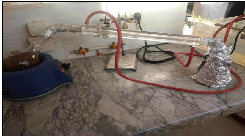
Figure.19: Montage d'hydro distillation simple pour l'extraction de l'huile essentielle (Balach, Achir & Bari, 2024).
