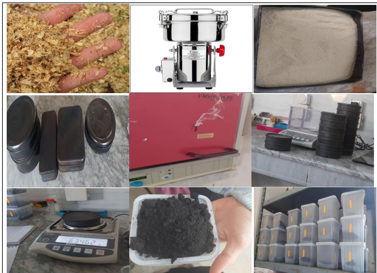
Figure 11 : Etapes de production de biochar.
