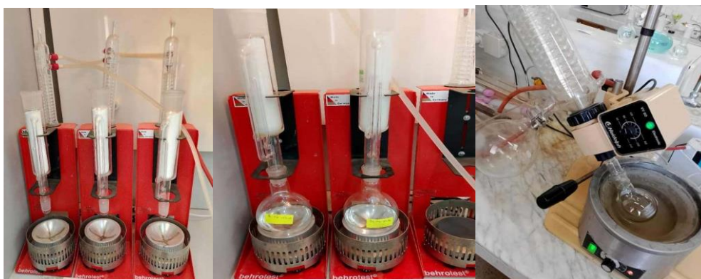
Figure 19 : Etape d'extraction de l'huile de jujubier par soxhlet.
