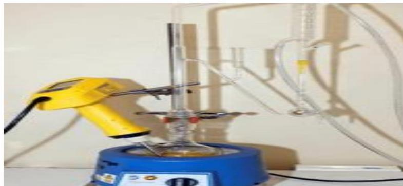
**Figure 7 :** Dispositif d'extraction d'huile essentielle par ultrasons
