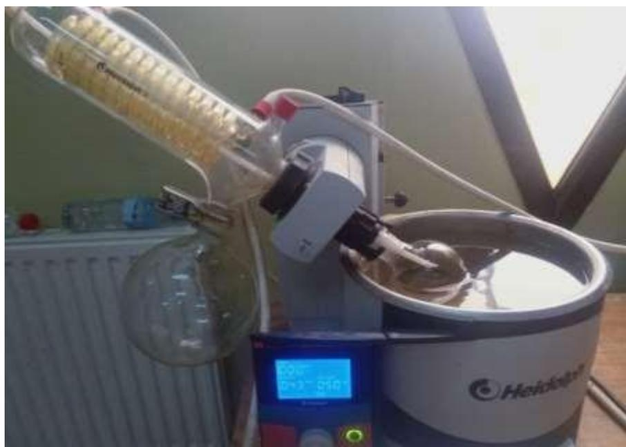
**Fig. 27: Evaporation des extraits par Rotavapor (Heidolph).**
