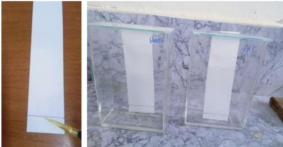
**Fig.24:** Montage des plaques CCM dans les cuves
