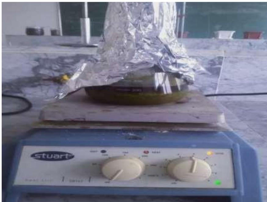
**Fig.25 : Macération à froid dans le méthanol 100% 24h**
