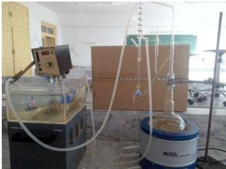
**Fig.22** : Montage d'hydro distillation au niveau de laboratoire de biochimie
