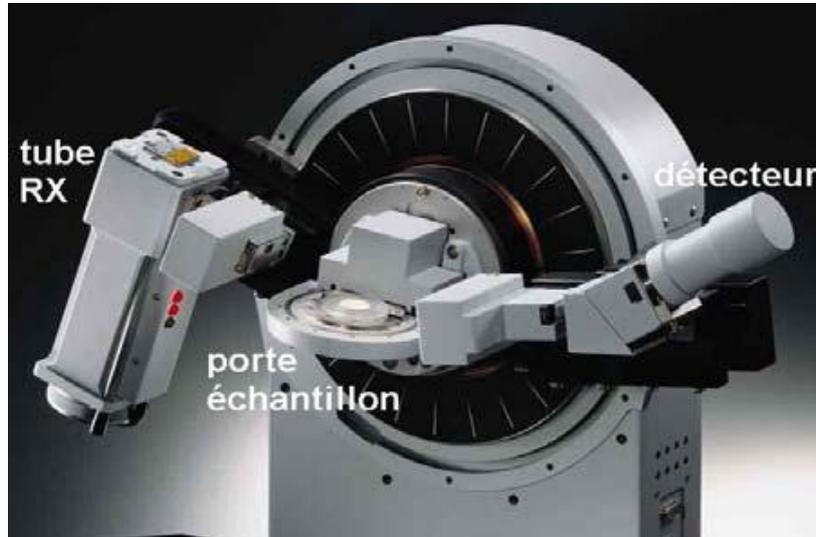
**Figure II.2 Diffraction de rayon X, géométrie de détection du diffractomètre en mode  $\theta$ - $2\theta$**
