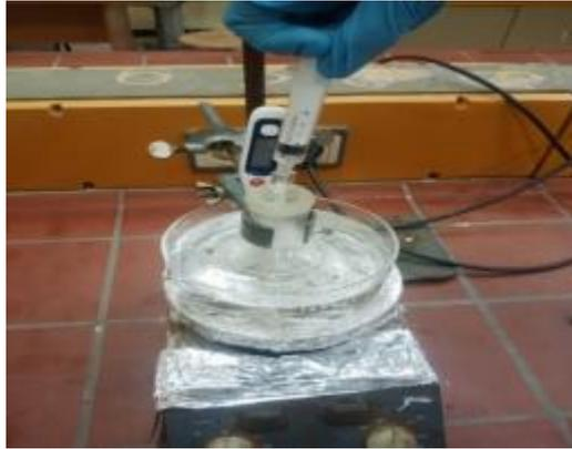
**Figure II.4 :** Dispositif expérimental utilisé pour la libération de l'antibiotique encapsulé.
