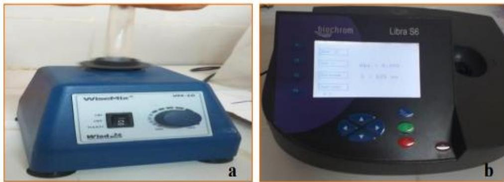
**Figure II.7 :** (a) : vortex, (b) : spectrophotomètre UV.
