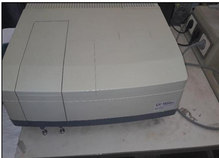
**Figure II. 9 :** spectrophotomètre UV-visible.
