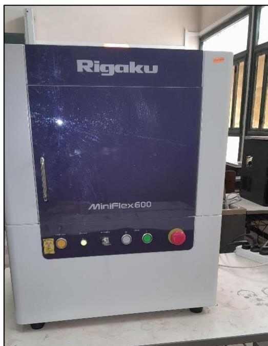
**Figure II. 8:** Diffractomètre DRX de marque Mini Flex 600 Rigaku.
