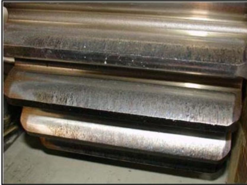
**Figure30; Grippage modéré sur les flancs d'un engrenage cémenté trempé [42]**
