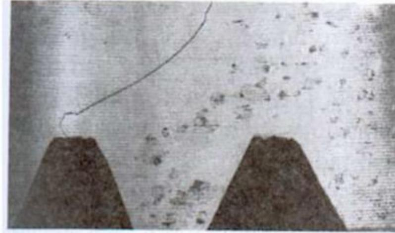
**Figure33: Fissuration au pied de la dent.**
