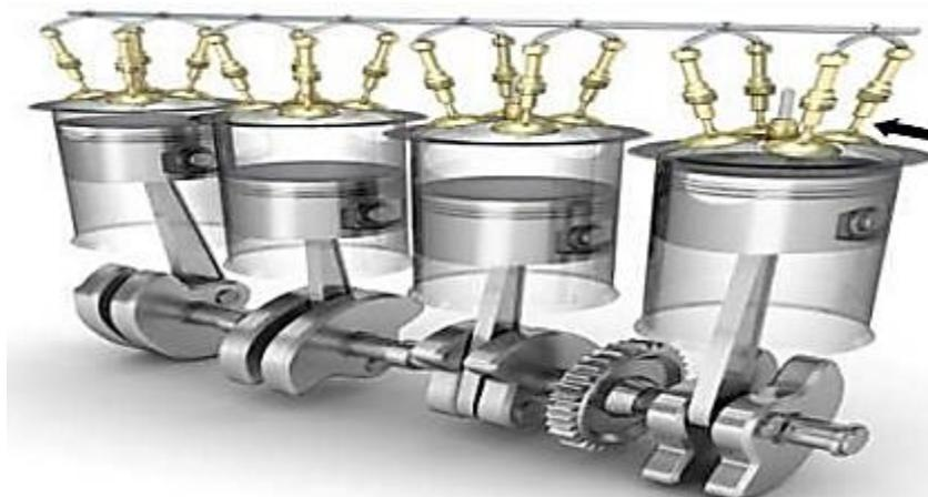
Figure I.2 : Moteur type en ligne [4].
