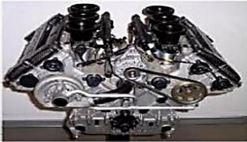
Figure I.3 : Moteur classique à combustion en V [4]
