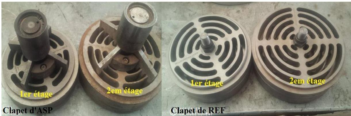
Figure 2.8: Clapet d'aspiration et de refoulement
