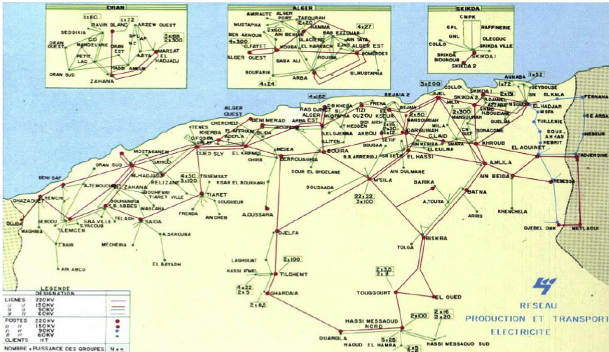
Figure(4.11) Topologie du réseau algérien de production et de transport à 59 bus.
