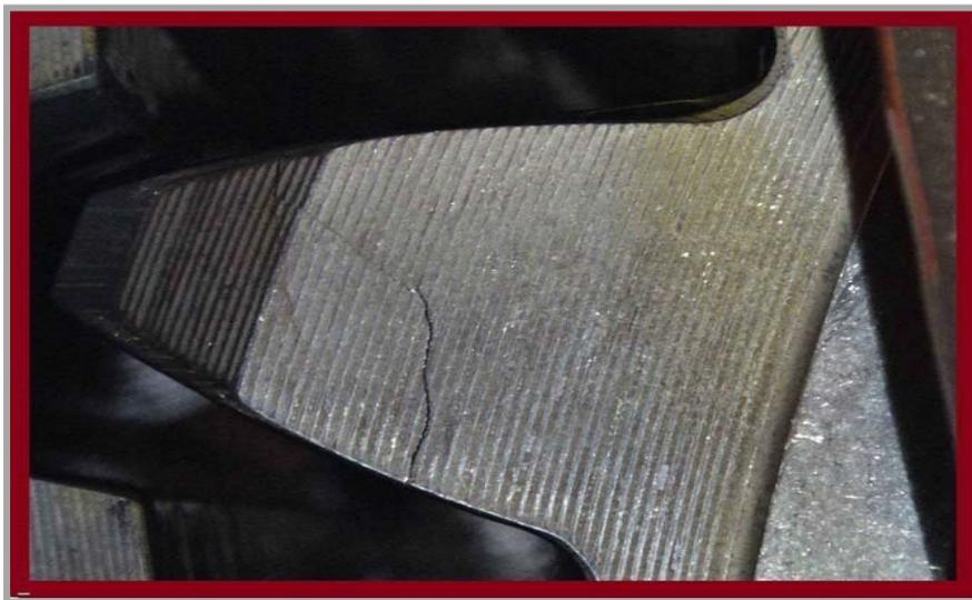
*Figure II.11 Rupture d'une dent planétaire de la boîte de vitesse*
