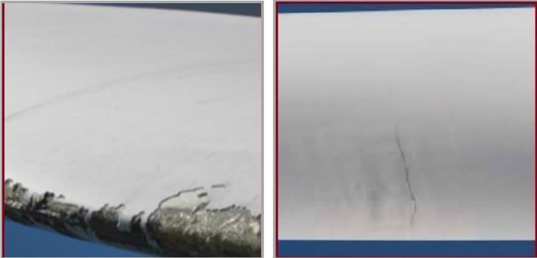
Figure II.12 Erosion et Fissure d'une pale.
