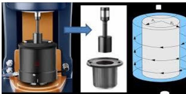
Figure II.20 : Rhéomètre cylindrique [31].
