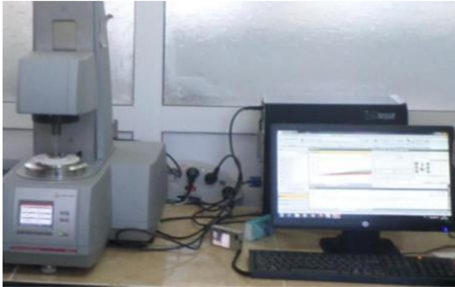
**Figure III.15 :** Un MCR302 mis en marche.
