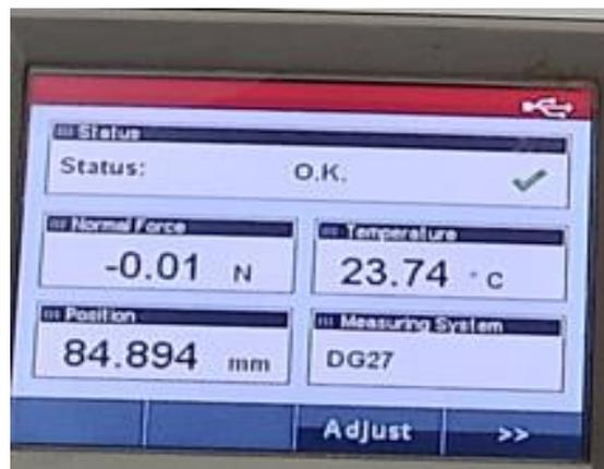
Figure III.8 : un écran du rhéomètre (MCR).
