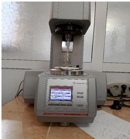
Figure III.4 : Rhéomètre Modular compact 302.
