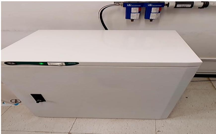
**Figure III.11** : compresseur lié à un MCR302.
