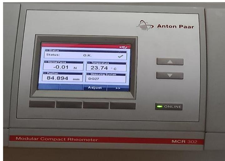
Figure III.9 : panneau de commande du rhéomètre MCR 302.
