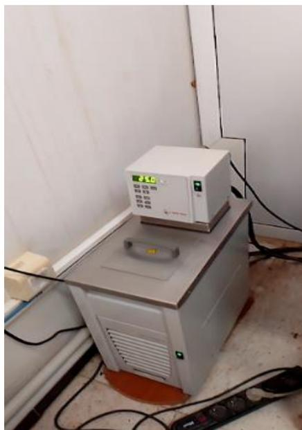
**Figure III.6 :** Bain de circulation d'un MCR.
