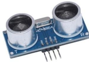
Figure 2.11 Capteur HC-SR04
