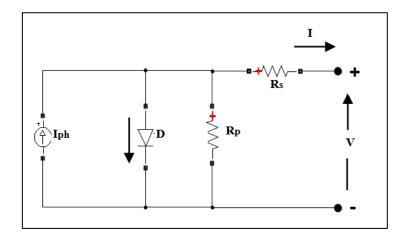
Figure II-1: Modèle électrique d'une cellule photovoltaïque [31].
