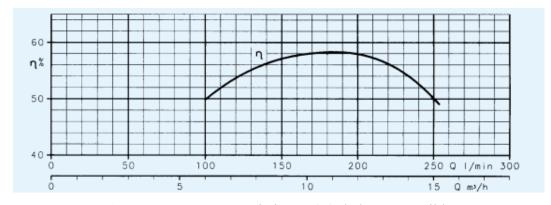
Figure III-12 : Caractéristique  $\eta(Q)$  de la pompe cible.
