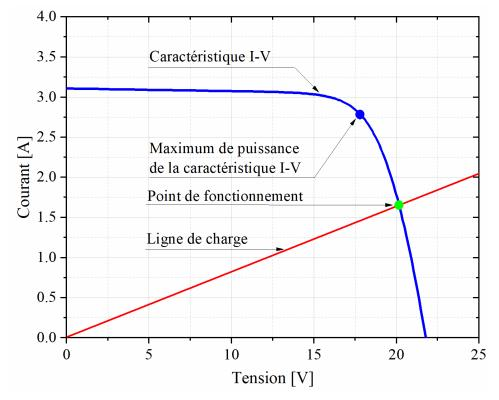
Figure II-11: Fonctionnement d'un panneau photovoltaïque.
