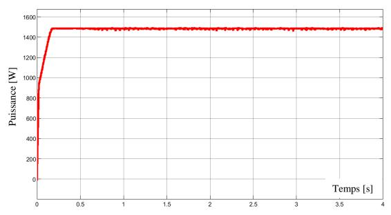
**Figure III-19 :** Puissance débitée par le générateur PV ( $G = 500 \text{ W/m}^2 \text{ et T} = 35 \,^{\circ}\text{C}$ ).
