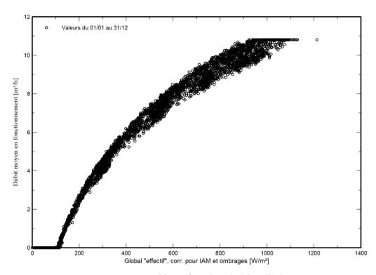
Figure III-7 : Débit en fonction de l'irradiation.
