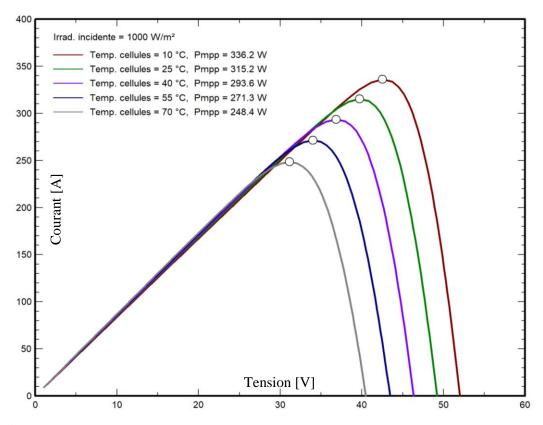
Figure II-10: Variation du MPP avec la température pour une irradiation fixée [33].
