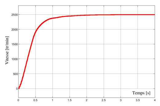
**Figure III-14 :** Evolution de la vitesse de rotation de la pompe.
