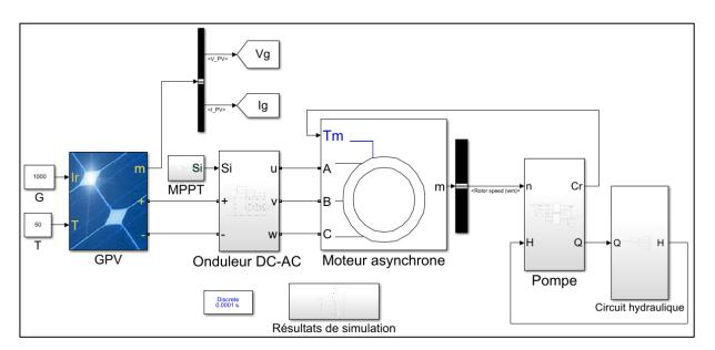
Figure III-10 : Modèle de la simulation sous Matlab.
