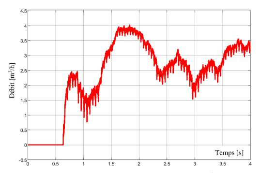
**Figure III-17 :** Evolution du débit de la pompe ( $G = 500 \text{ W/m}^2 \text{ et T} = 35 \text{ °C}$ ).
