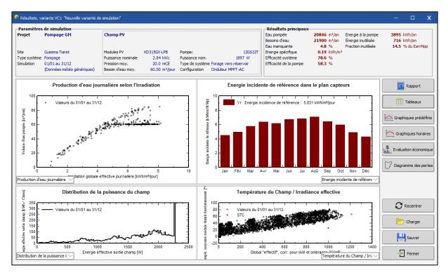
Figure III-6 : Résultats de simulation sur PVsyst.
