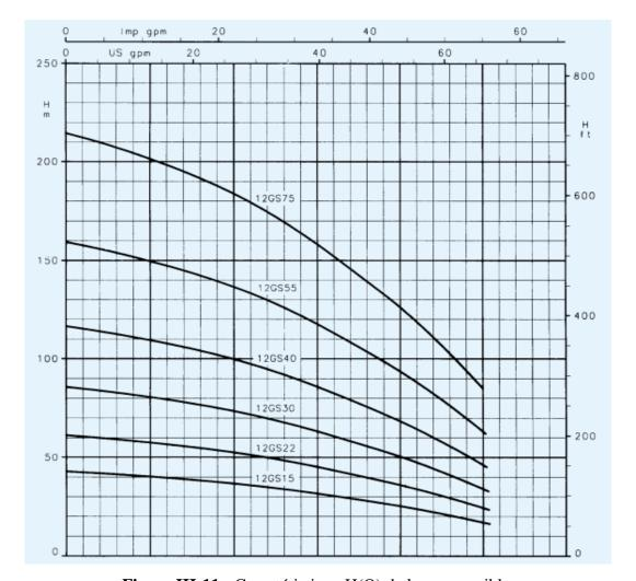
**Figure III-11 :** Caractéristique H(Q) de la pompe cible.
