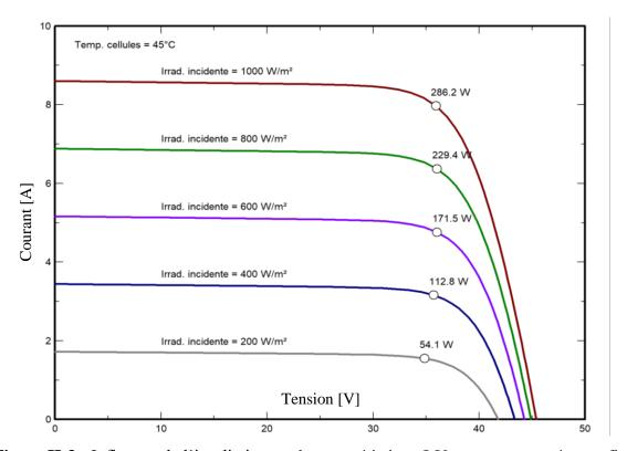
Figure II-3 : Influence de l'irradiation sur la caractéristique I-V pour une température fixée.
