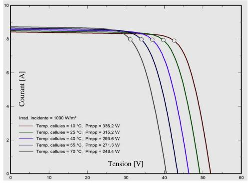
Figure II-4: Influence de la température sur la caractéristique I-V pour une irradiation fixée.
