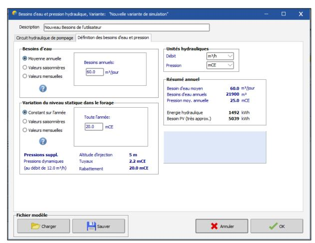
Figure III-3 : Définition des besoins d'eau et résumé annuel.
