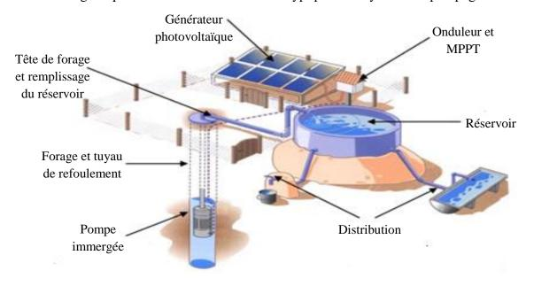
Figure III-1 : Schéma d'un système de pompage solaire.
