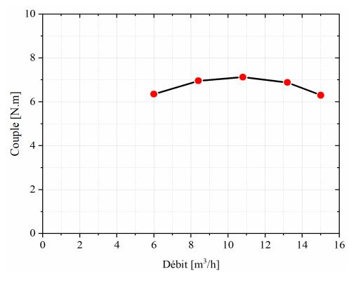
Figure II-8 : Caractéristique typique  $C_r(Q)$  de la pompe pour une vitesse fixée.
