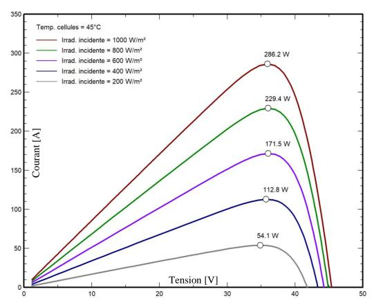
**Figure II-9 :** Variation du MPP avec l'ensoleillement pour une température fixée [33]. La figure qui suit montre le MPP sur la caractéristique I-V pour différentes températures avec une irradiation fixée.
