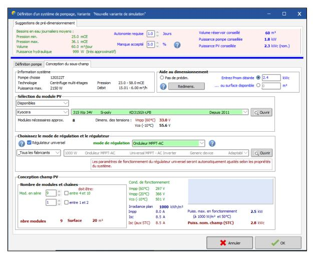
Figure III-5 : Choix de la pompe, du panneau et du mode de régulation.
