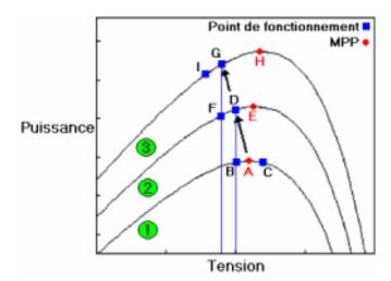
Figure II-12: Illustration du fonctionnement de l'algorithme "P&O" [35].
