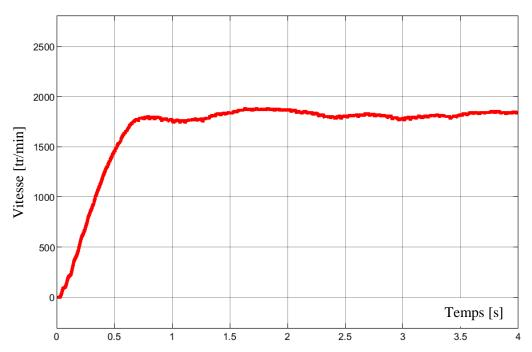
**Figure III-18 :** Evolution de la vitesse de la pompe ( $G = 500 \text{ W/m}^2 \text{ et T} = 35 \,^{\circ}\text{C}$ ).
