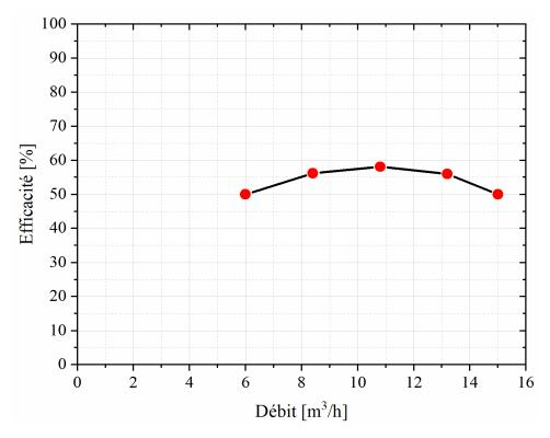
**Figure II-7**: Caractéristique typique  $\eta(Q)$  de la pompe pour une vitesse fixée [33].
