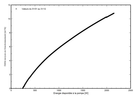
Figure III-8 : Débit en fonction de la puissance à la pompe.
