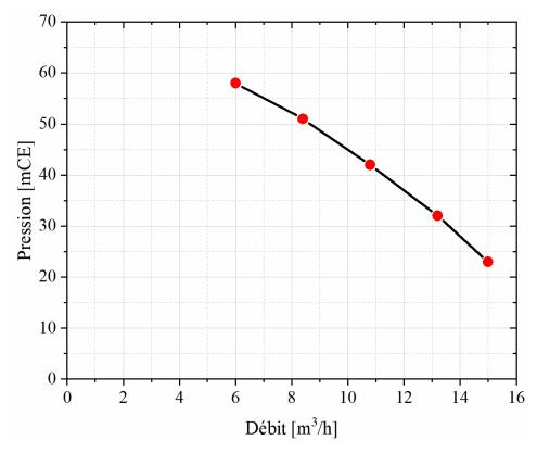
Figure II-6 : Caractéristique typique H(Q) de la pompe pour une vitesse fixée [33].
