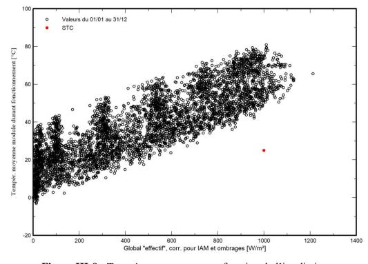
Figure III-9: Température moyenne en fonction de l'irradiation.
