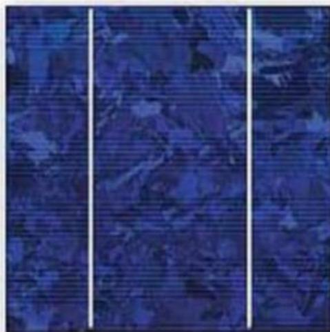
Figure I.6 : Matériaux solides cristallisés : Polycristallin [8]
