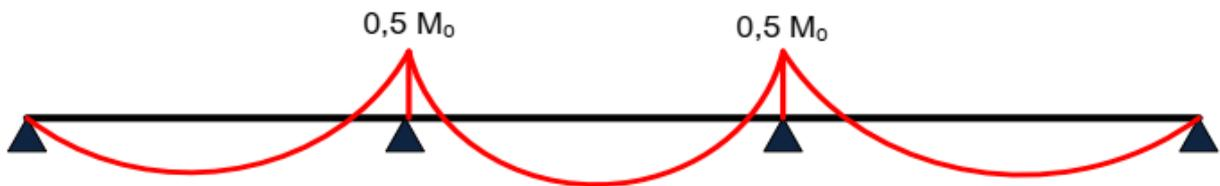
Figure IV-7- Diagramme des moments fléchissant de poutre à trois travées
