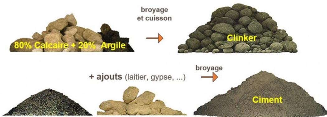
Figure I .4 : les principes méthodes du fabrication de ciment
