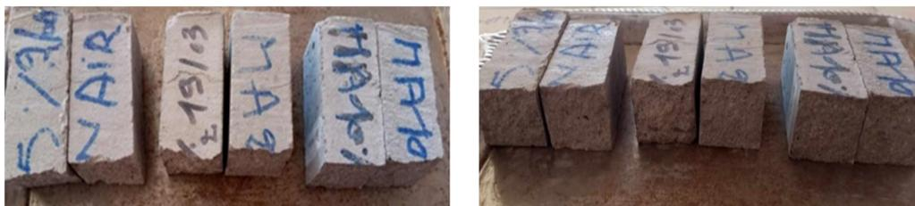
**Figure IV.1** : Analyse des Résultats de l'Essai de Résistance de Traction par Flexion et de Compression à 7, 14 et 28 Jours
