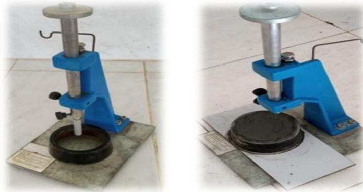
Figure III.2 Appareille de Vicat
