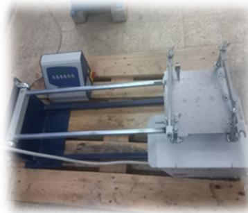
**Figure III.15 :** Agitateur d'éprouvettes (table à choc). (Labo de génie civil TIARET)
