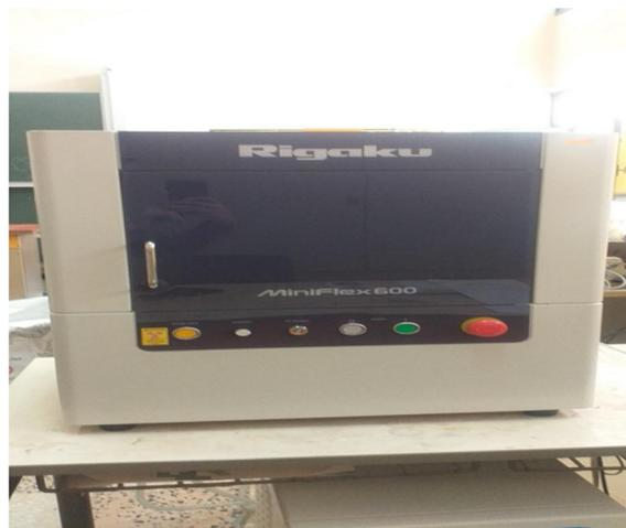
Figure III .12 : Le Diffractomètre (Laboratoire de synthèse et catalyse TIARET)
