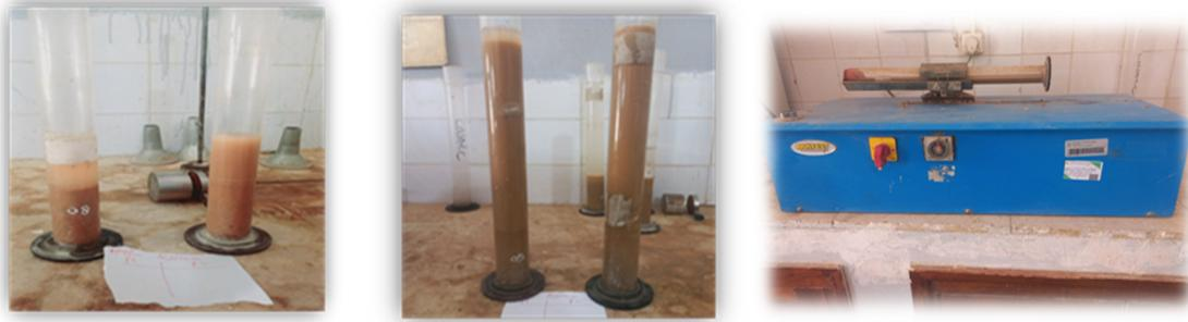
Figure : III .8 Equivalent de sable (au niveau de laboratoire LTPO Tiaret)
