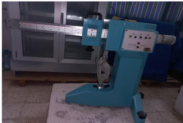
Figure III.18: machine de flexion
