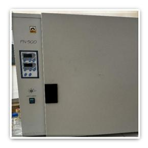
Figure  $N^{\circ}25$ : Four Pasteur
