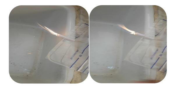
**Figure 8:** Détection de biogaz par le test de flamme (*Photo originale*)
