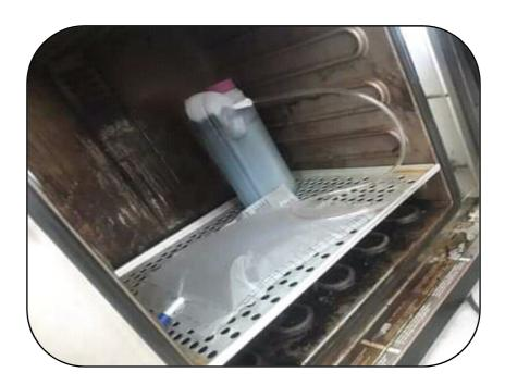
Figure 7: Montage du digesteur pour la production de biogaz (Photo originale)
