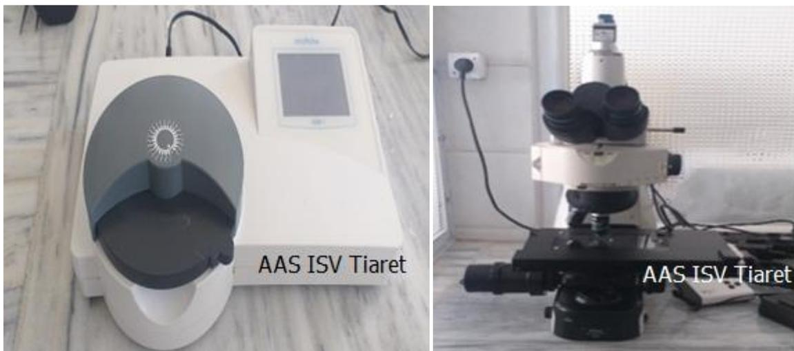
**Photo 02 :** Photomètre minutube SDM 1, étalonné pour les équidés et CASA (photo personnelle).
