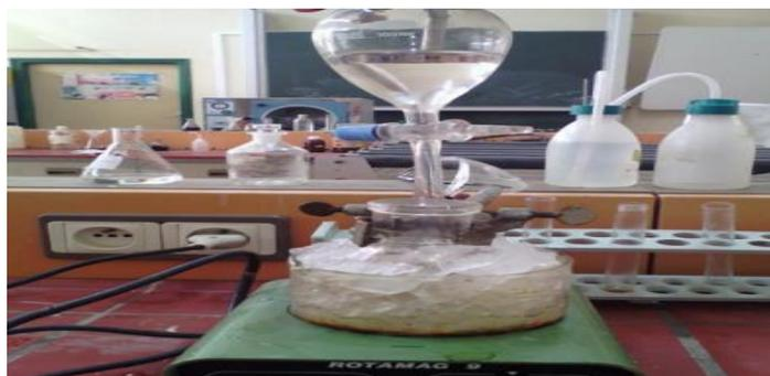
**Figure V.1 :** le montage de la synthèse de poly aniline
