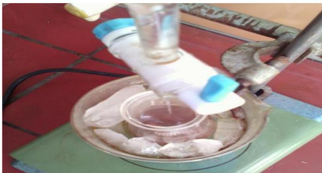
**Figure 4** : le montage de la synthèse de poly aniline avec un liquide ionique
