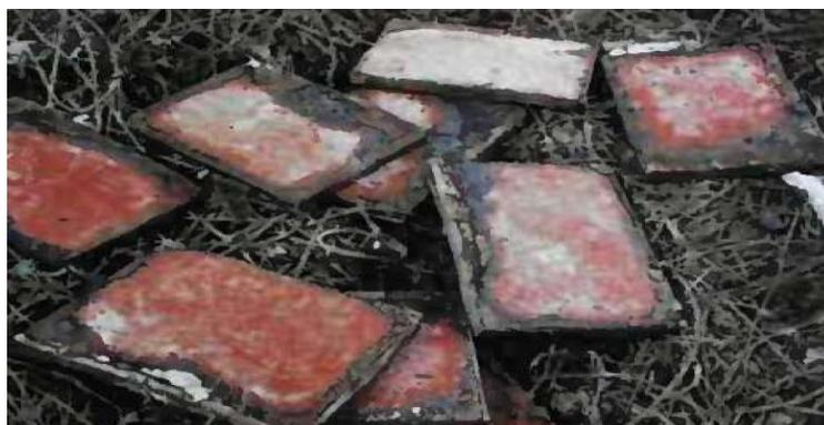
**Figure II.10** Corrosion des frettes en acier
