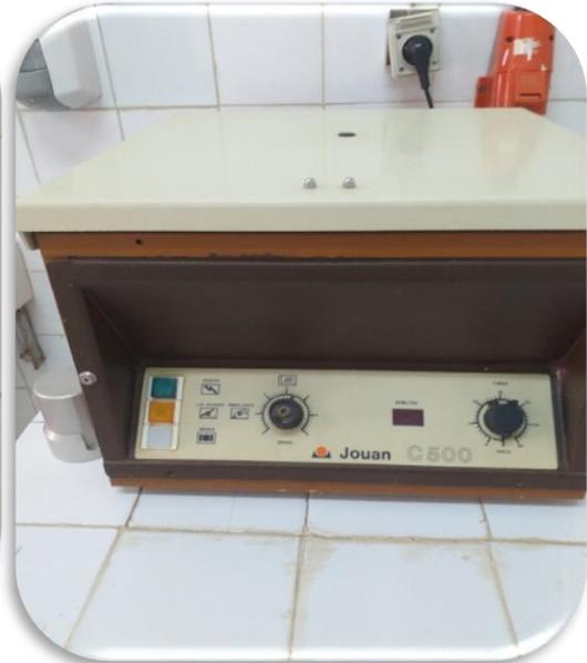
**Photo 12** : Centrifugeuse à une accélération de 2000g.
