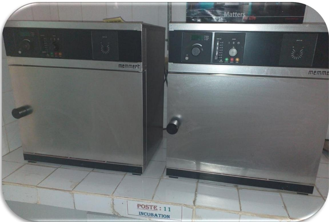
**Photo 13** : Etuve réglable à  $30^{\circ}\text{C} \pm 1^{\circ}\text{C}$  et à  $25^{\circ}\text{C} \pm 1^{\circ}\text{C}$
