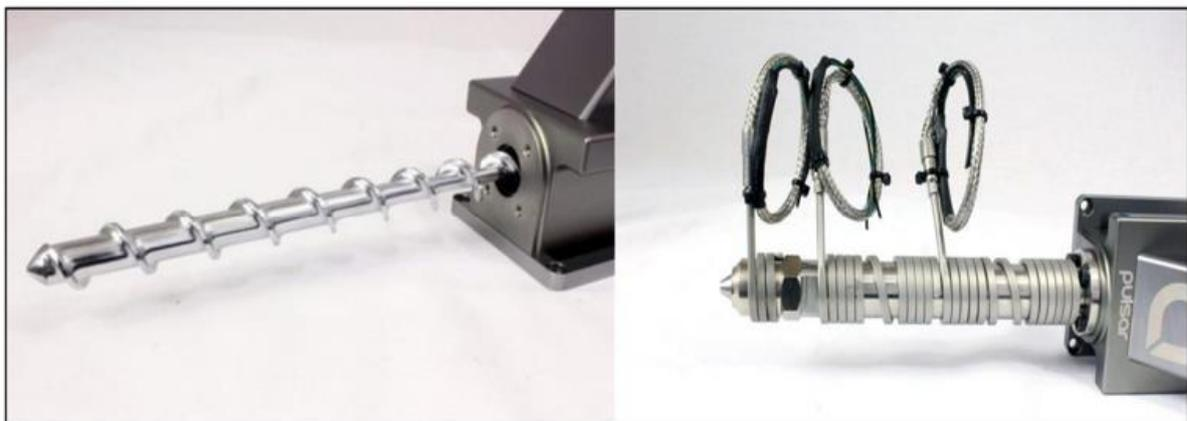
**Figure 2.8 :** Extrudeur à vis.
