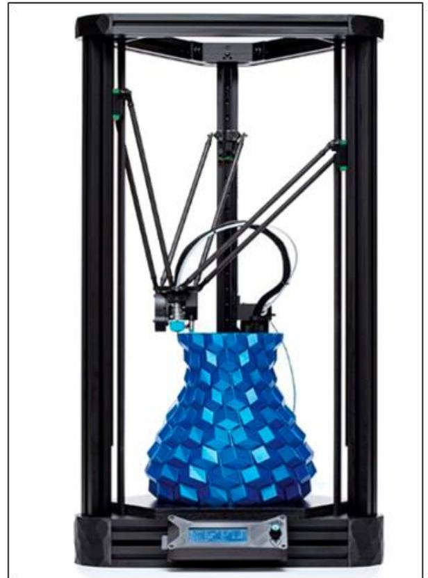
**Figure 2.6 :** exemple d'imprimante Delta.
