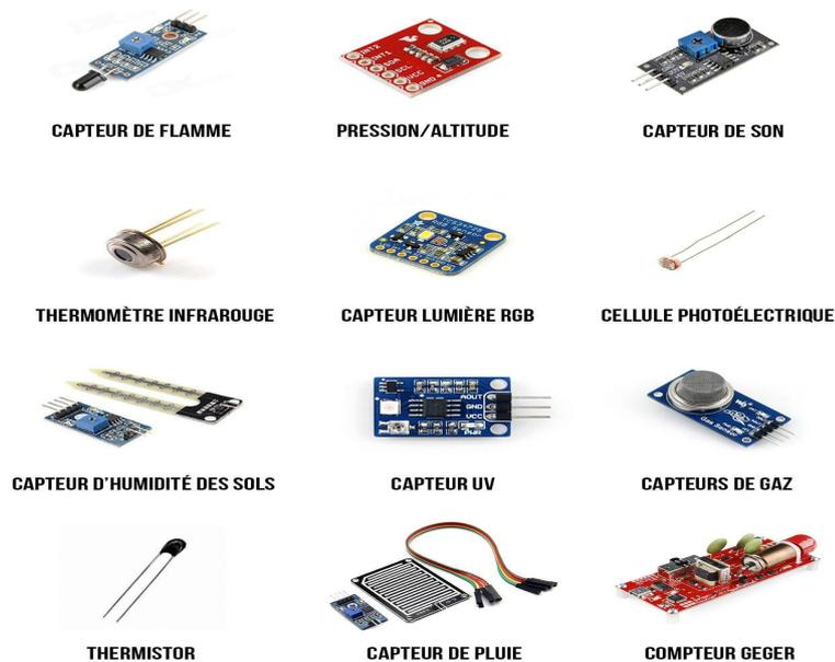
FIGURE 1.2: Des exemples de capteurs [2].
