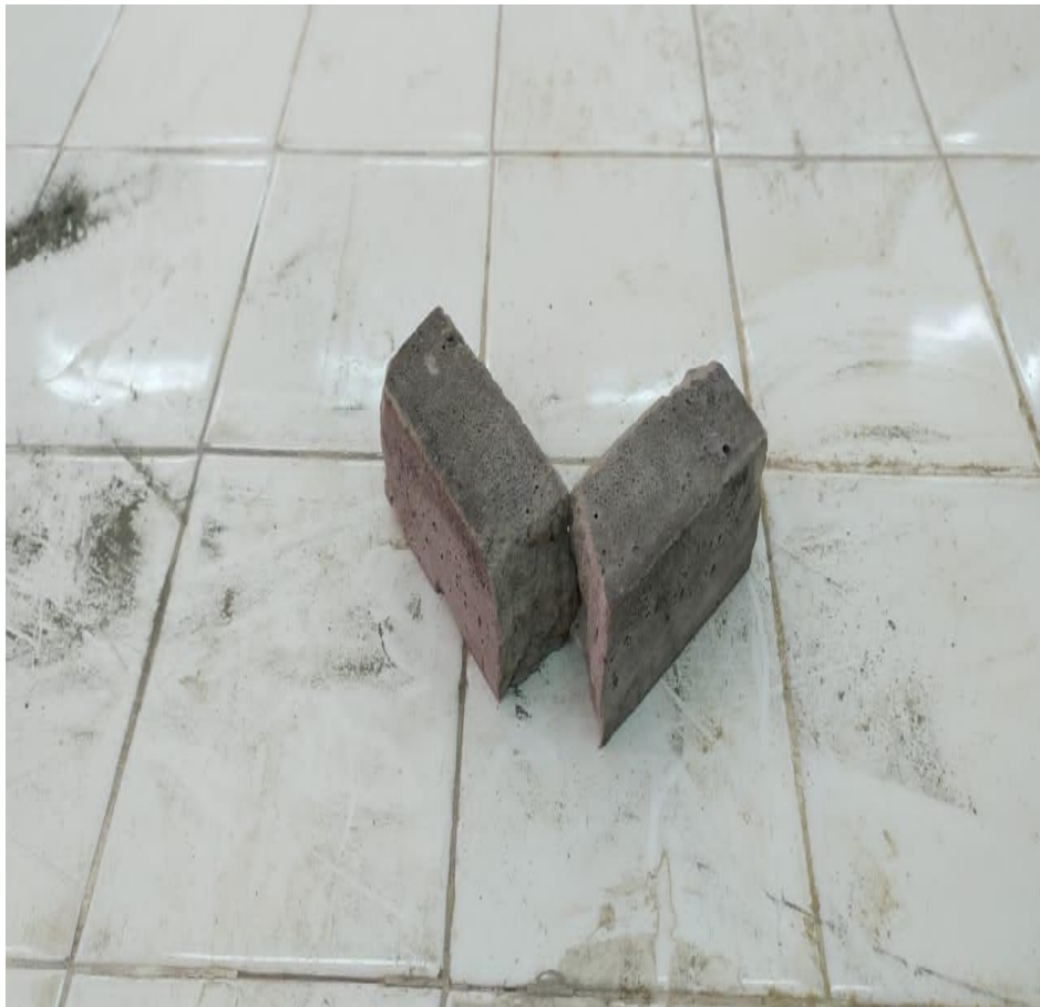
Figure 4, 9. Rupture d'un Mortier témoin.
