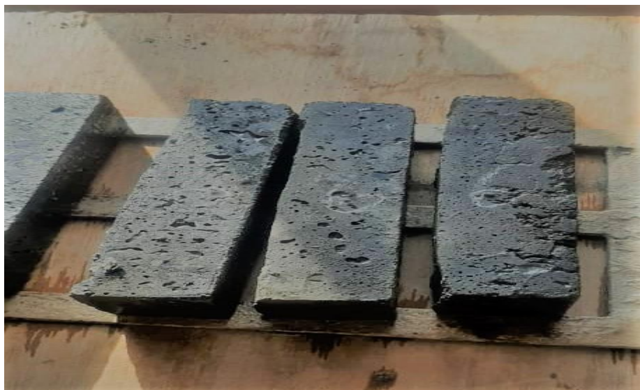
Figure 4.2 : Mauvais remplissage des moules.
