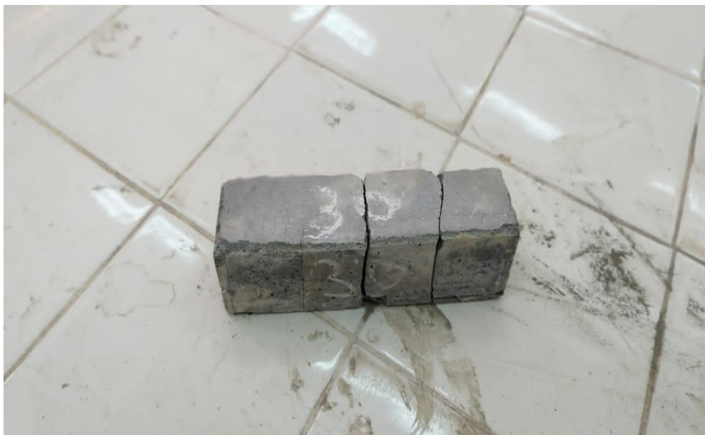
Figure 4.10 Rupture d'un Mortier renforcé.
