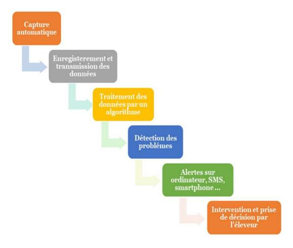
Figure 04 : principe de fonctionnement des capteurs
