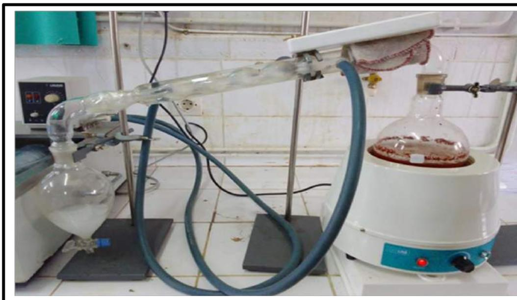
**Figure 2-1** : Dispositif d'hydro-distillation lors d'extraction des huiles essentielles
