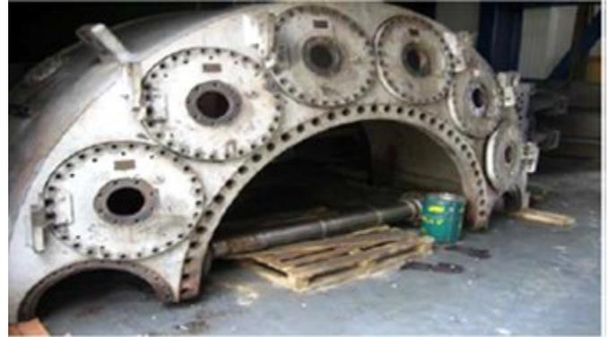
Figure.II-2:Carter des chambres de combustion
