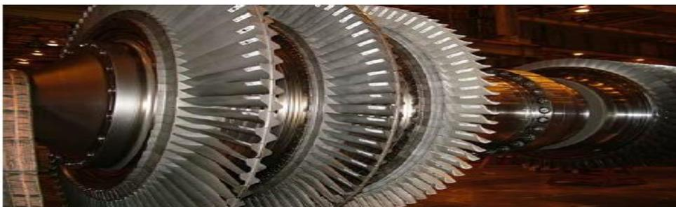
Figure. II-7 : Turbine à gaz.
