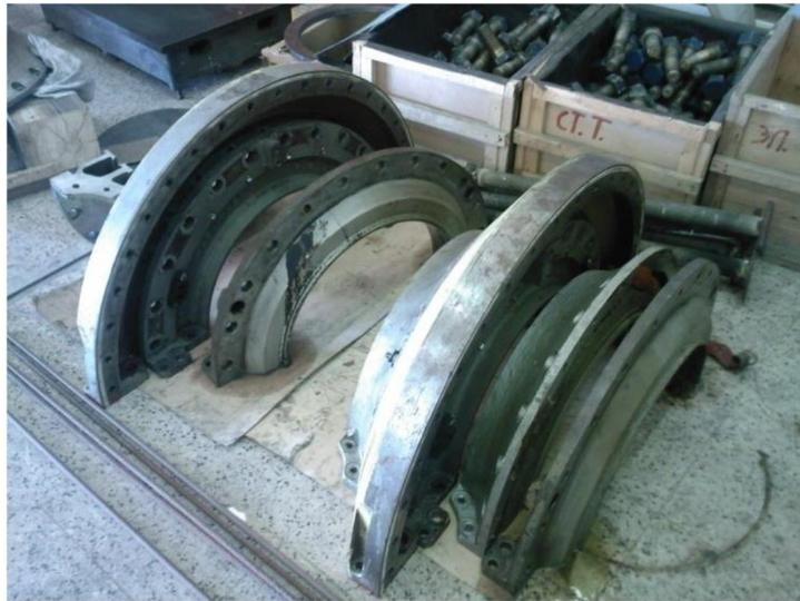
Figure II.21 : Joint d'huile de l'arbre.
