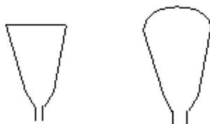
Figure II.6 : Encoches demi-ouvertes
