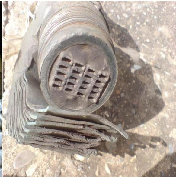
Figure II.10: La tête de Barre statorique de la centrale de JIJEL
