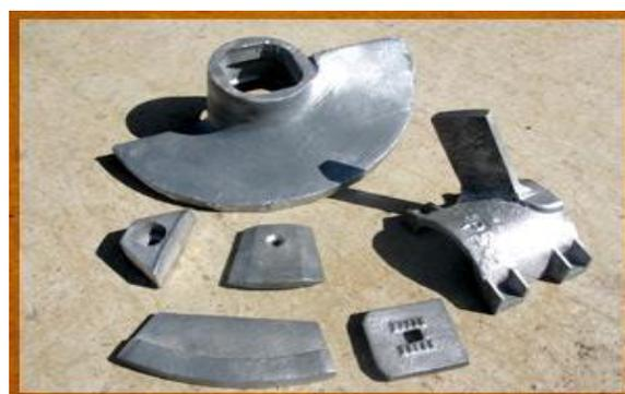
Figure I.6 : Hélice et Portes pales.
