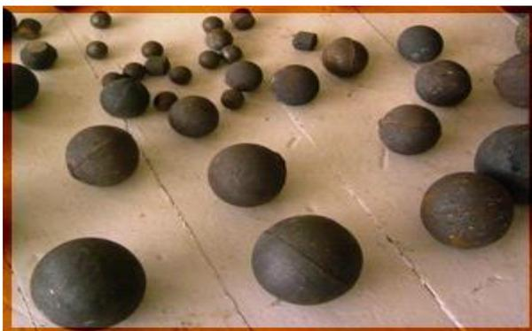
Figure I.7 : Boulets de broyage.
