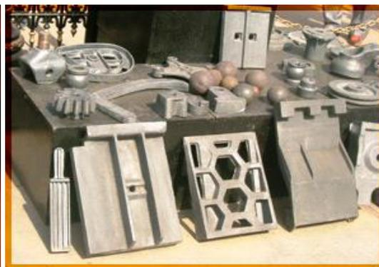
Figure I.8 : Pièces d'usure diverses.
