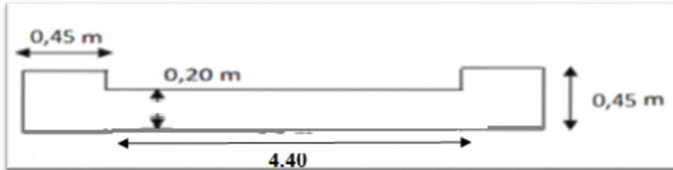
**Figure VII.1:** Schéma du voile + poteaux
