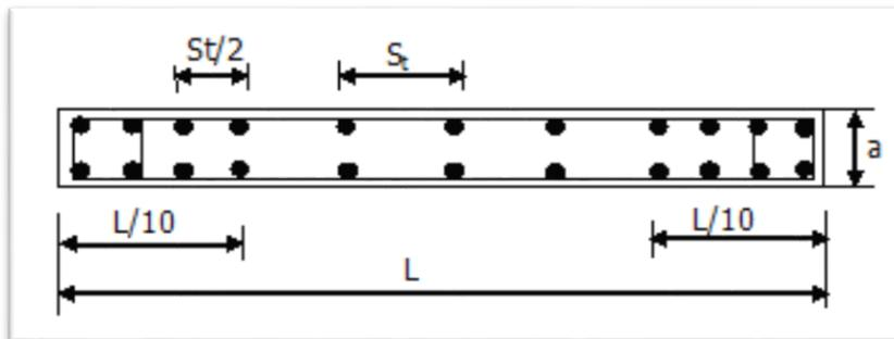
Figure VII.4 : Disposition des armatures verticales dans les voiles selon le RPA
