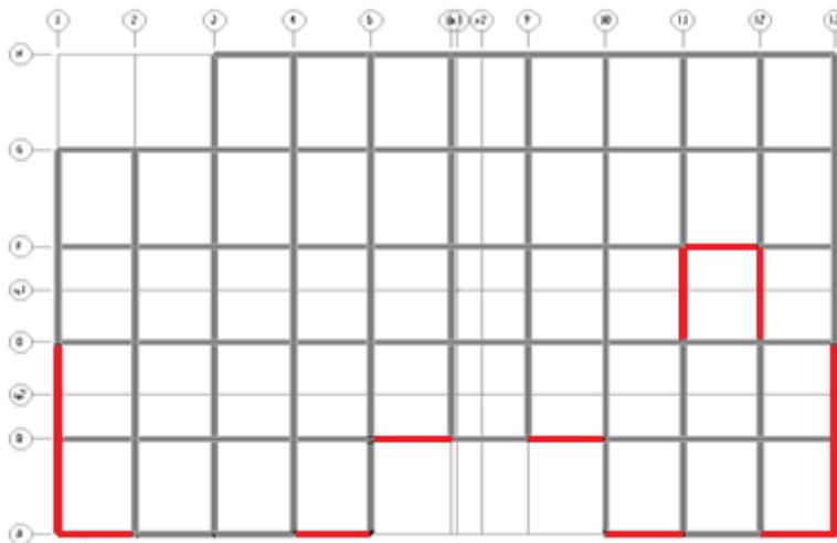
**Figure VII.2:** Disposition des voiles dans la structure (du la terrasse jusqu'au RDC)
