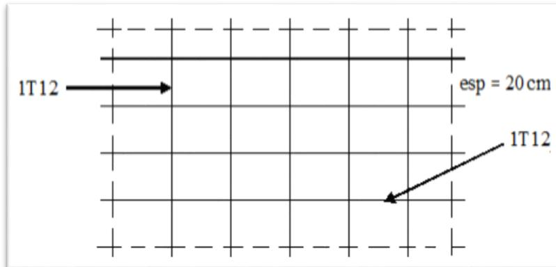
Figure VII.3 : La disposition du ferrailage du voile.
