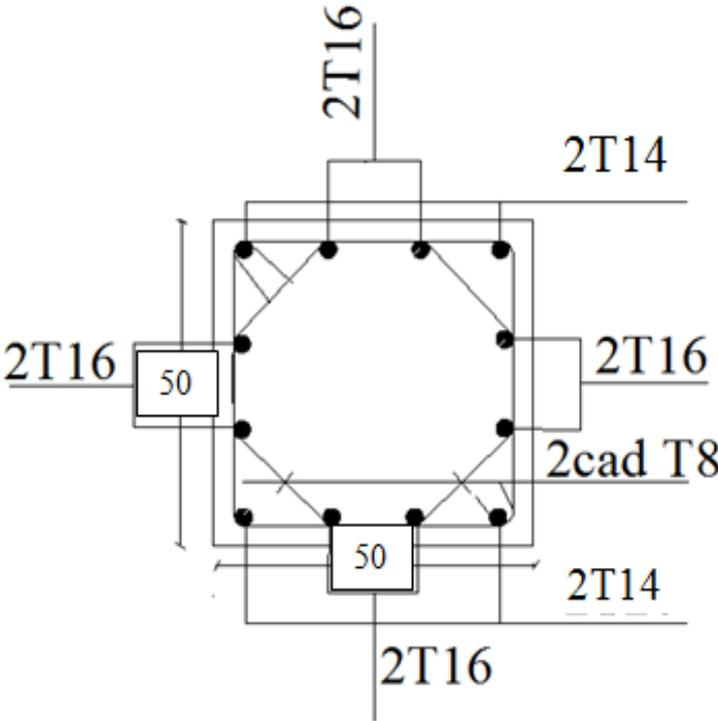
Figure .VI.2 : Exemple du ferrailage du poteau (50x50)
