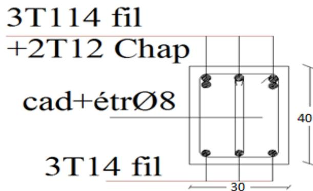
Figure .VI.1 : Exemple du ferrailage d'une poutre principale
