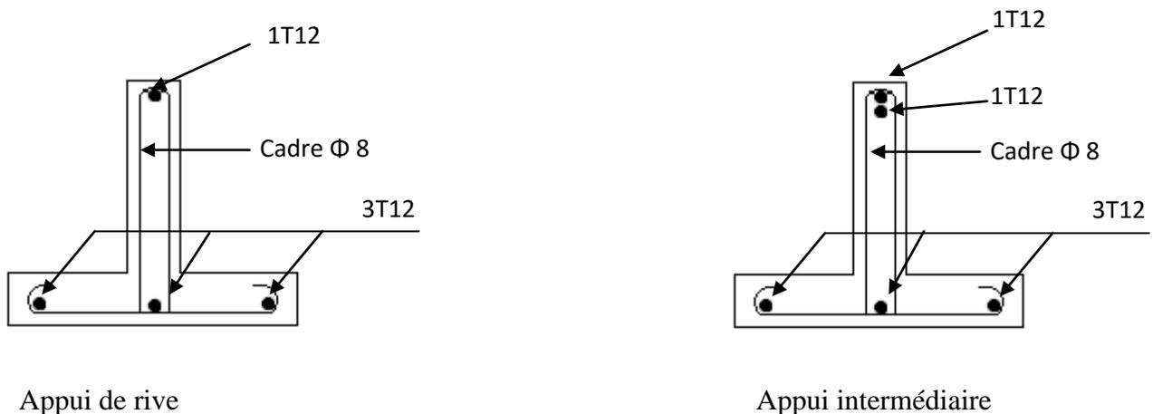
Figure.IV.4 : Dessin de ferrailage des poutrelles du plancher terrasse
