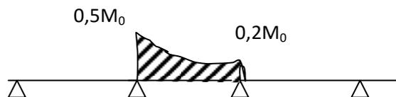
Les appuis B et C devront avoir une section correspondante au moment résultant (partie hachurée de la figure ci-dessus) qui peut être déterminée par la formule suivante :
