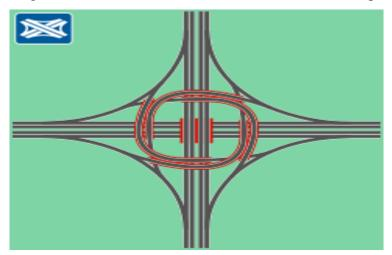
Figure II.5 : Echangeur en turbine simplifié
