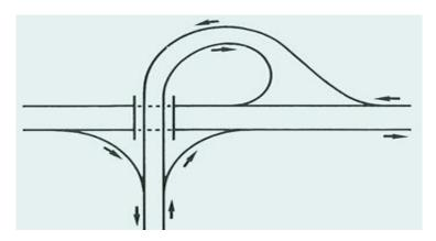
Figure II.6: Echangeur en trompette
