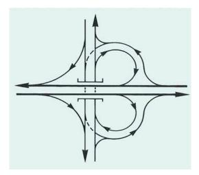
Figure II.3 : Echangeur autoroutier en demi-trèfle
