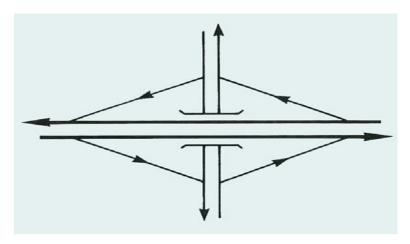
Figure II.7: Echangeur en losange
