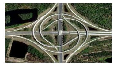
Figure II.4: Échangeur en turbine complète
