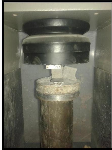
**Figure.IV.07** :Ecrasement des éprouvettes à 7 jours
