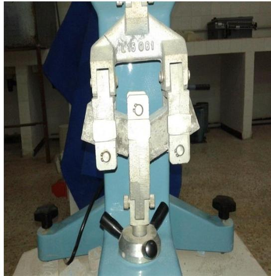
Figure.IV.04 : Ecrasement des éprouvettes prismatique (4x4x16) cm<sup>3</sup>
