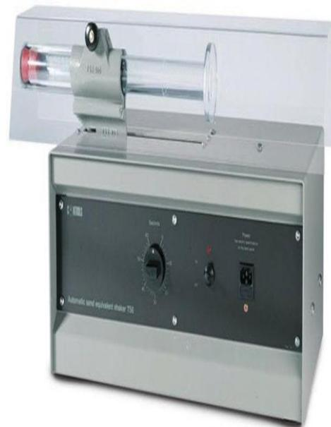
**Figure. III.7 :** Machine d'agitation E.S. [39]
