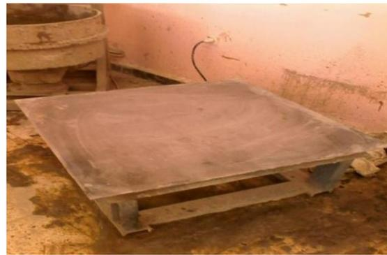
Figure.III.16 : la table à vibration.
