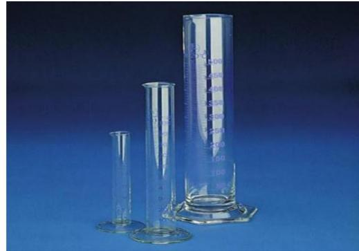
**Figure. III.8 :** Les éprouvettes utilisés pour mesuré la masse volumique absolue . [39]
