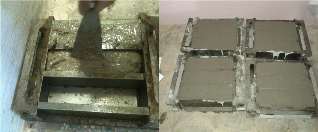
**Figure.III.17** : remplir les éprouvettes.
