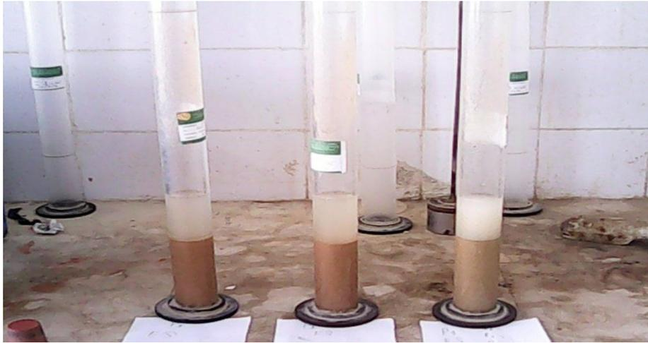
**Figure. III.5 :** Essai d'équivalent de sable.
