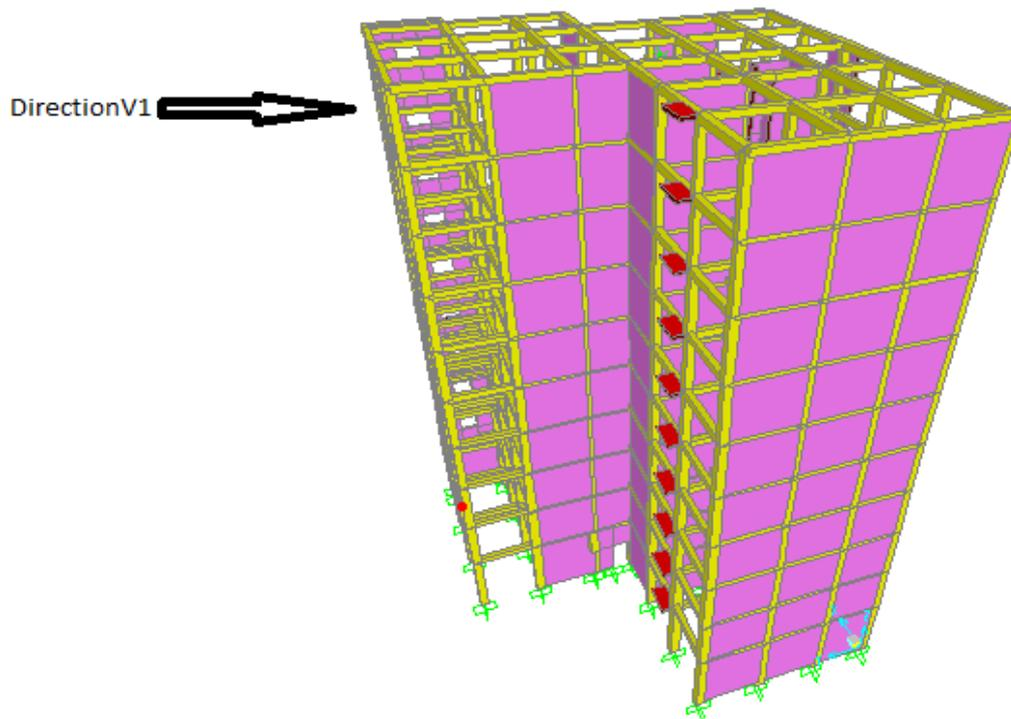
La structure du bâtiment étant en béton armé, on utilise l'abaque de la figure 3.1 de La RNV99 pour déterminer le coefficient
