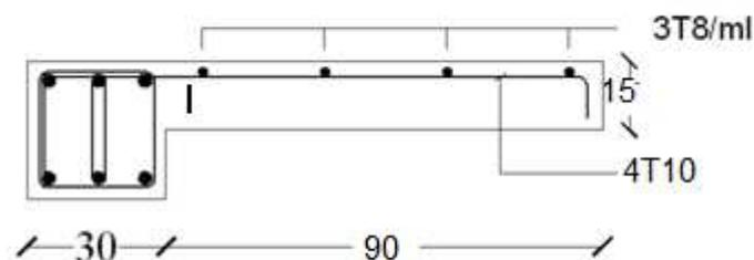
FigureIV.11 :Détail de ferraillage des balcons.
