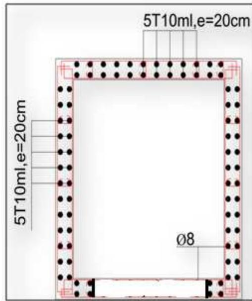
Figure IV.13 :Ferrailage d'ascenseur
