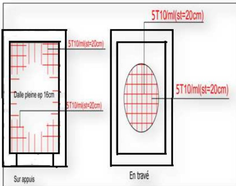
Figure IV.14 :Ferrailage de la dalle d'ascenseur
