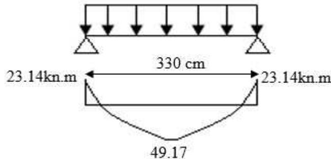
Figure IV-2-1- Diagramme des moments que subit la poutre palière.
