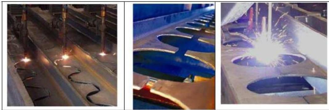
**Figure 1. 6.** Oxycoupage du profilé de base, séparation et soudage des deux parties
