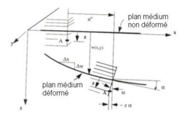
Figure II.6: Plan Medium dans un Stratifié Déformé [30]
