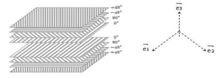
Figure II.2: Stratifié Quasi-Isotrope [45°,-45°,].
