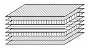
Figure II.1 : Stratifie Constitue de Couches Parfaitement Liées
