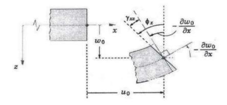
Figure II.10: Illustration de la plaque de (FSDT) [1].
